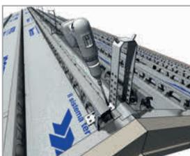
Das mögliche Fehlen der Ziegelträgerlatte in der Nähe des Firstes wird mit einer entsprechenden Isotec-Latte kompensiert, die über die Platte an der Struktur zu befestigen ist. Diese Ausführung gewährleistet die Kontinuität des Trägers der Dachziegel. Es ist ratsam, die Verschlussplatten mit Polyurethanschaum zu verbinden und mit der Butyl-Aluminiumbeschichtung zu versiegeln.
