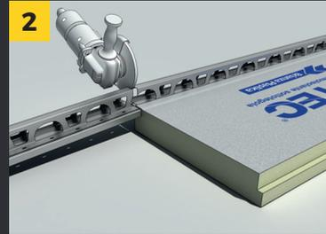
ten etwa einen Meter voneinander entfernt sein. Die seitlichen Panelfugen und die Köpfe der Befestigungen werden durch Butylaluminiumband abgedichtet.
