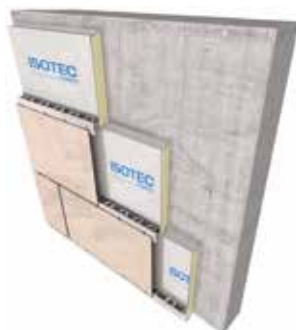
Sistema con rivestimento in lastre in fibrocemento
