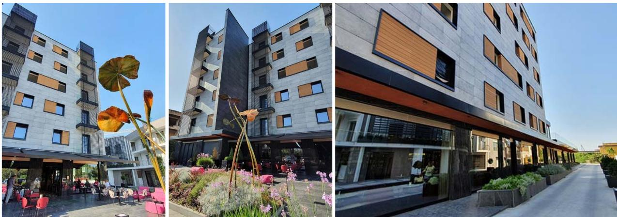
Dal punto di vista materico gli elementi metallici in colore grigio scuro degli infissi, del rivestimento dei cornicioni e dei balconi, creano un vivace contrasto con l'aspetto naturale della ceramica chiara del rivestimento e del WPC effetto legno dei sistemi oscuranti. Per le pareti laterali senza finestre, il rivestimento di facciata è stato realizzato con lo stesso tipo di grès ma in colore grigio antracite, dando ritmo all'estetica dell'insieme.
